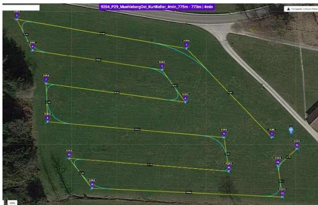
Der Flugplan stellt sicher, dass die Drohne immer 60 Meter über Grund fliegt und die Abstände zwischen den Flugbahnen rund 25 Meter beträgt. Die Wärmebildkamera deckt aus einer Höhe von 60 Metern eine Breite von etwa 34 Metern ab, so dass eine Überlappung der Flugbahnen besteht. Wird auf dem Monitor ein heller Fleck angezeigt, wird die Drohne gestoppt und eine Person (Retter) prüft, warum eine Wärmequelle angezeigt wird. Dies kann
